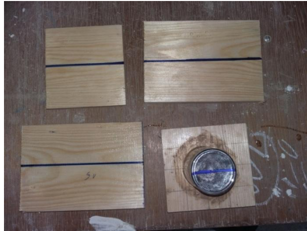
Figure III.5 : Nettoyage et savonnage le coup verre et les planchettes.
