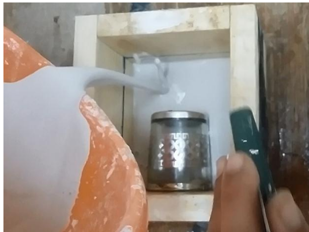
Figure III.6 : Couler le plâtre (remplir jusqu'a de l'axe horizontal du cylindre (la coupe de verre)).
