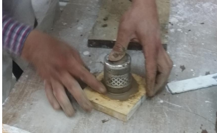
Figure III.3 : Fixer la pièce modèle sur l'entourage tracé.
