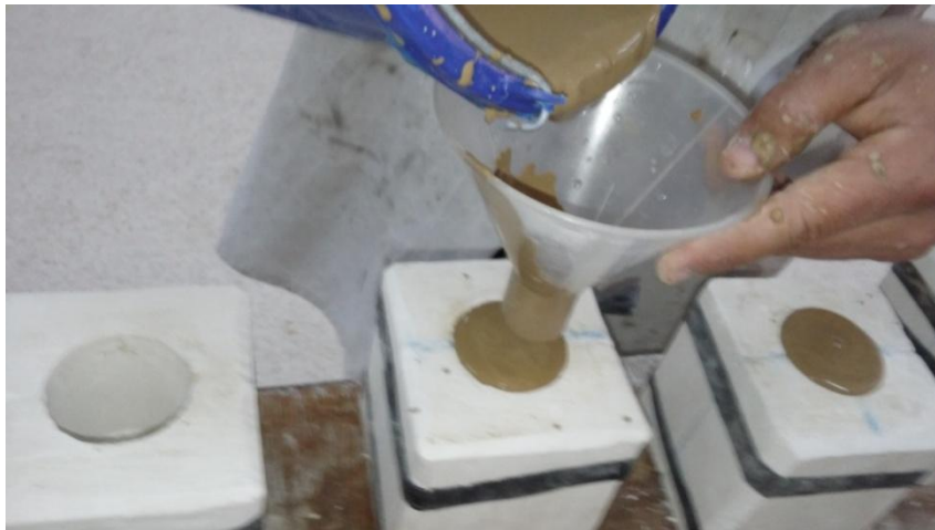
Figure III.15 : le coulage en ciel ouvert.
