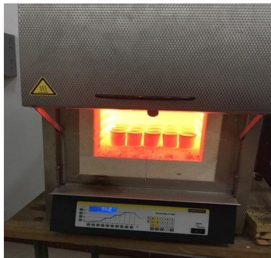
Figure.III.22 : frittage des échantillons.
