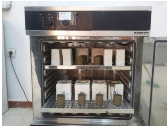
Figure III.11 : Séchage des moules.
