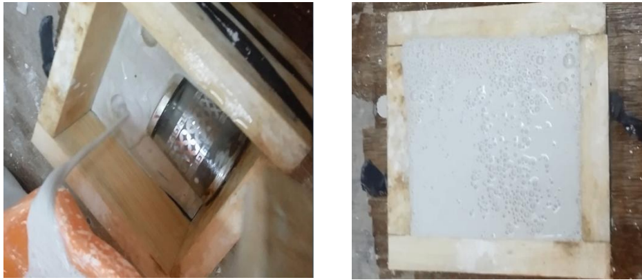
Figure III.9 : Couler le plâtre (remplir jusqu'à la limite).
