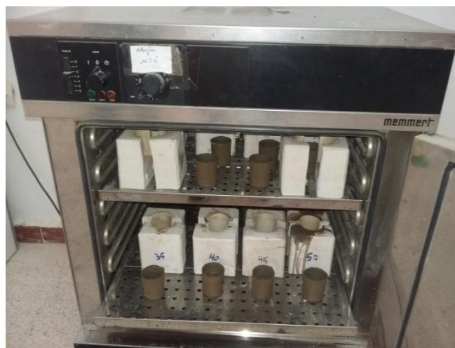
Figure.III.21 : Séchage des biscuits.
